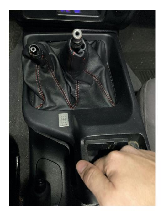
4. BEFORE YOU PULL THE SHIFTER BEZEL COMPLETELY UP, YOU WILL HAVE TO DISCONNECT THE WHITE ELECTRICAL CONNECTOR FOR THE ASHTRAY LIGHT. WHILE HOLDING BOTH SIDES OF THE CONNECTOR, PUSH DOWN ON THE TAB CIRCLED IN THE PICTURE AND PULL APART.
